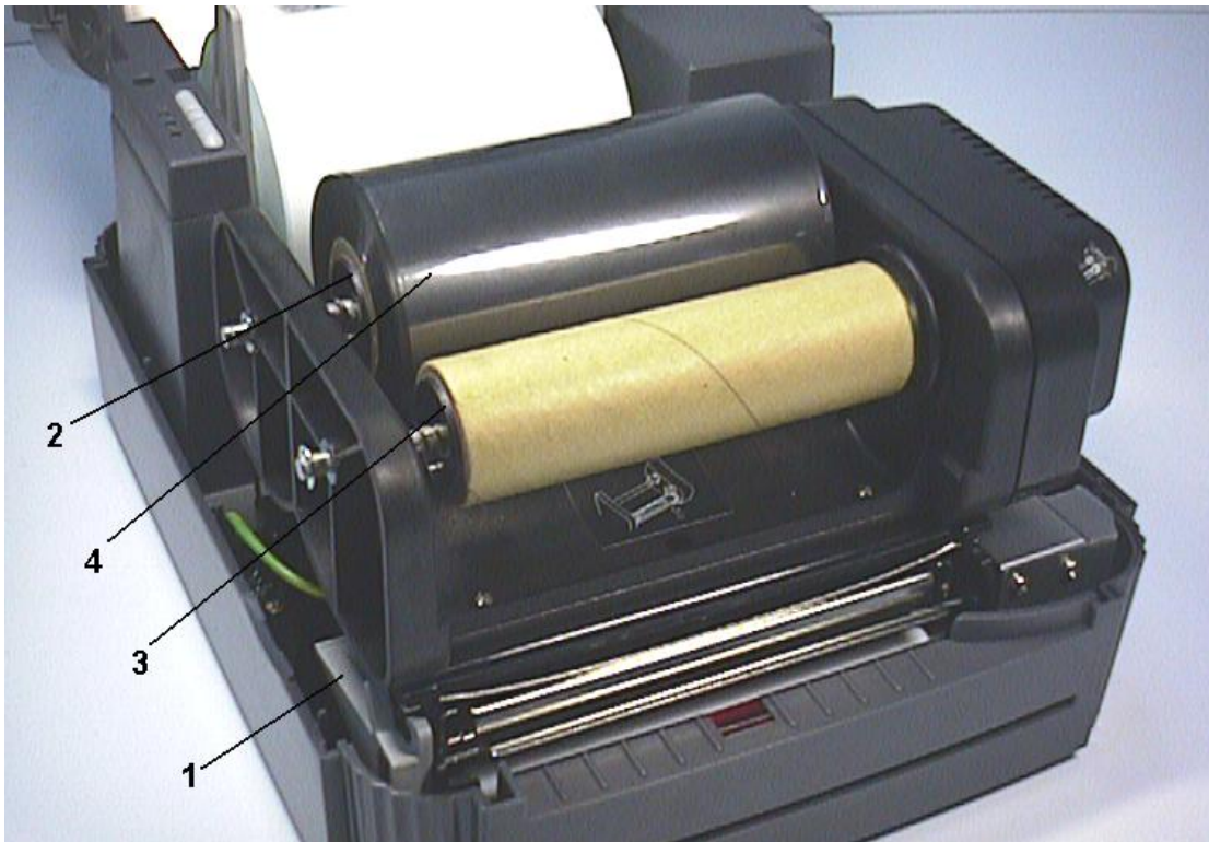
Figura 9. Colocación del rollo de suministro de cinta
